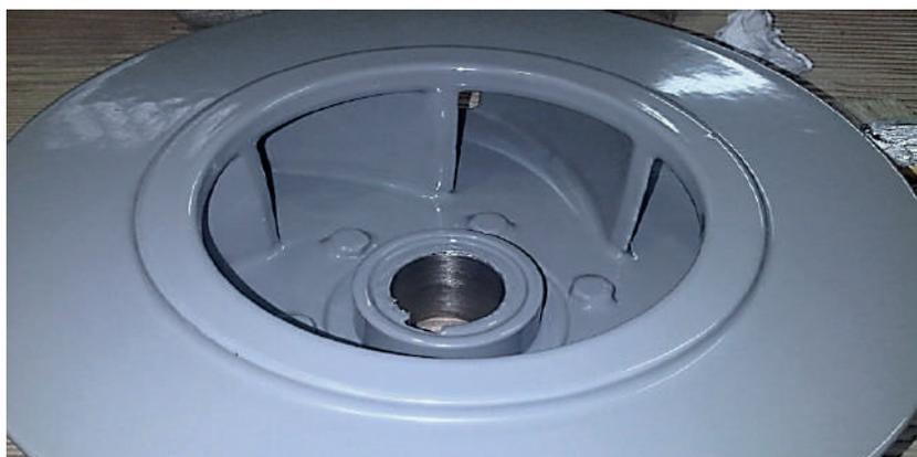
**Detalhes de Aplicação** ▶ Revestimento com Fluoropolímero Blue Armor® ECTFE + cargas antiabrasivas. Espessura Aplicada: 1,00 mm
