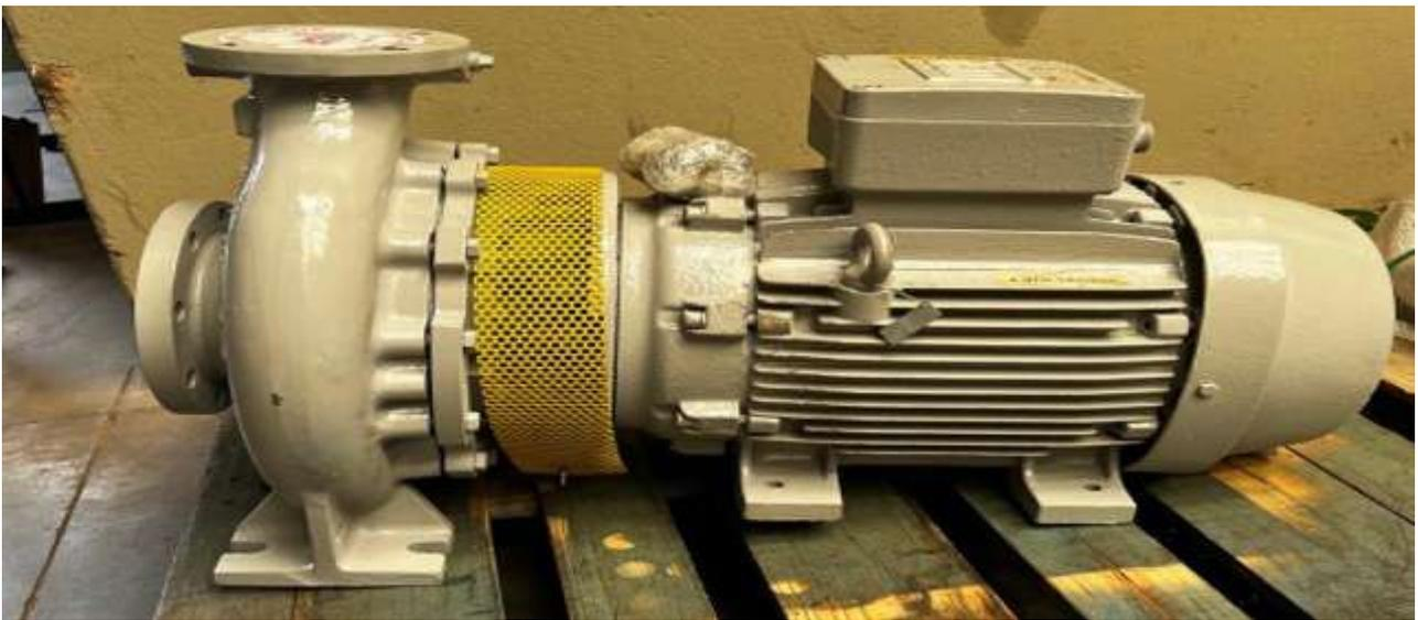
**Detalhes de Aplicação** ▶ Revestimento com Fluoropolímero ECTFE
